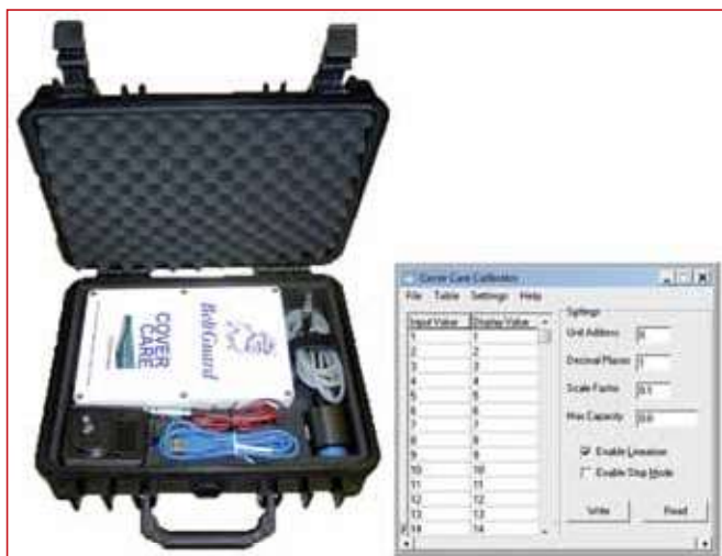
Rys. 11 Walizka na urządzenie CC222 i tablica do kalibracji systemu [34-35]
