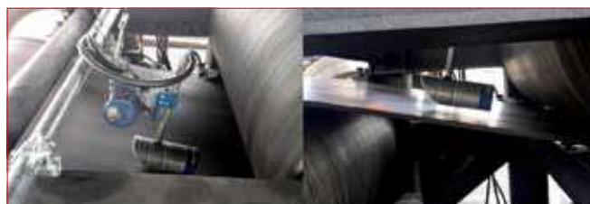
Rys. 15 Zdjęcia z realnych pomiarów grubości okładki systemem RCT firmy BeltScan Systems [35]
