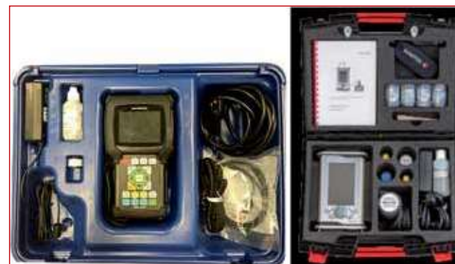
Rys. 8 Zawartość walizek do przenoszenia urządzeń ultradźwiękowych: przyrząd (Olympus 38DL Ultrasonic Digital Thickness Gauge – po lewej i Sonotec Sonowall 70 Thickness Gauge – po prawej), sondy, kable, bloki kalibracyjne, żel sprężający, próbki testowe, instrukcje obsługi i ładowarka
