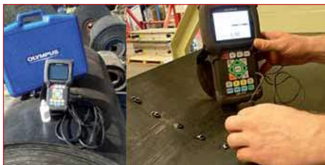
Rys. 5 Zestaw pomiarowy firmy Olympus z żelami sprężającymi i zdjęciami z pomiarów [46, 48]
