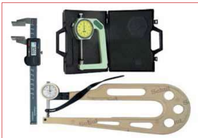
Rys. 1 Ograniczone możliwości pomiarów grubości taśmy przenośnikowej przy użyciu ręcznych grubościomierzy
