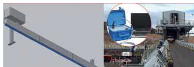
Rys. 19 Tester grubości taśm firmy Fenner-Dunlop (Fenner Dunlop Online Thickness Tester) [41]
