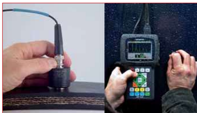
Rys. 3 Pomiary grubości taśmy/okładki przy użyciu urządzenia ultradźwiękowego firmy Olympus [46]
