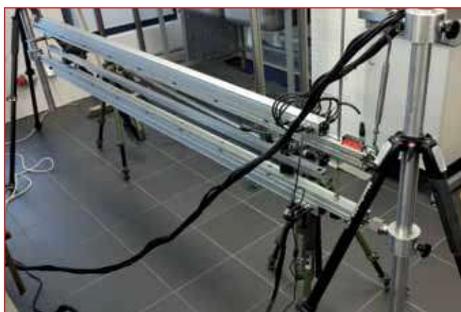
Rys. 2 Urządzenie do pomiaru grubości taśmy przenośnikowej DiagBeltSonic
